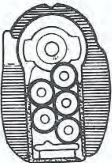
**Pri potiskivanju zatvarača unapred čelo tela zatvarača izbacuje prazan okvir, a donji deo čela zatvarača potiskuje gornji metak u ležište metka. Bradavica tela zatvarača klizi po uzdužnim žljebovima sanduka. Zub zapinjajuće klizi po žljebu repa sanduka, i kad nađe na Zub viljuške zaustavlja udarač s udarnom iglom.**
